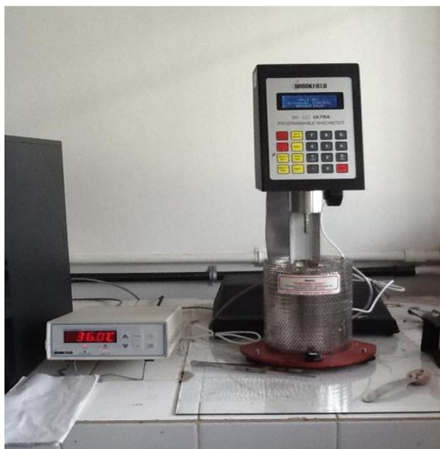
Figura 2.12 A: Reômetro, marca Brookfield, modelo DV III – ultra software: Rheocalc V3.3 – Analisador de tensão e taxa de cisalhamento, viscosidade dinâmica
