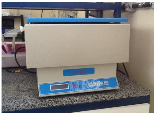
Figura 2.4: centrífuga para a separação das partículas sólidas do meio
