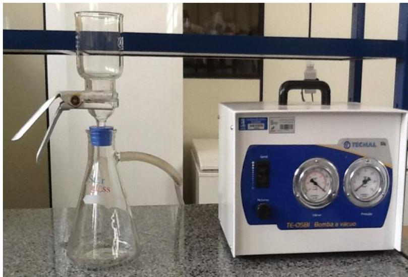
Figura 2.7: Filtração a vácuo com membrana
