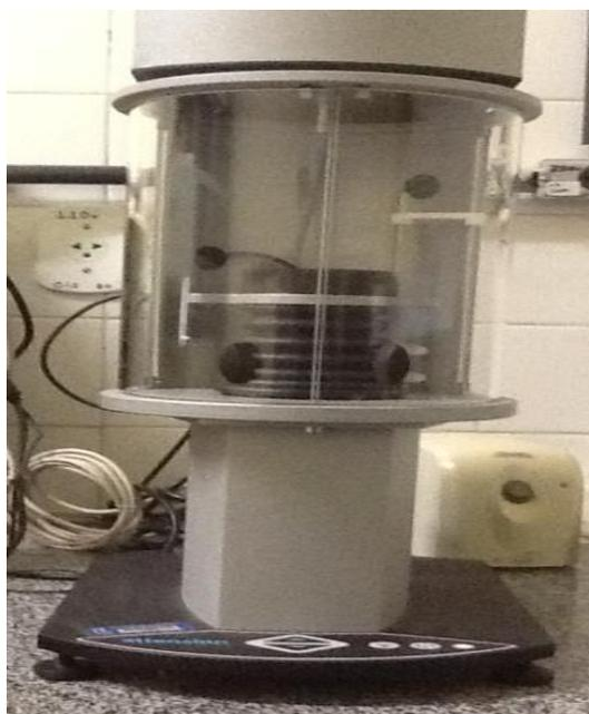
Figura 2.6: Tensiômetro para análise de tensão superficial
