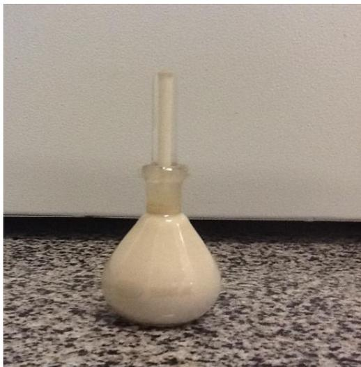
Figura 2.10: Picnômetro com emulsão de querosene
