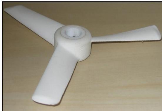
**Figura 2.8** Protótipo de impelidor de alta eficiência (L-CFD)
