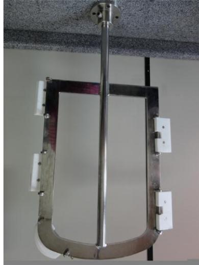
**Figura 2.11** Impelidor âncora reto com raspadores (L-CFD).
