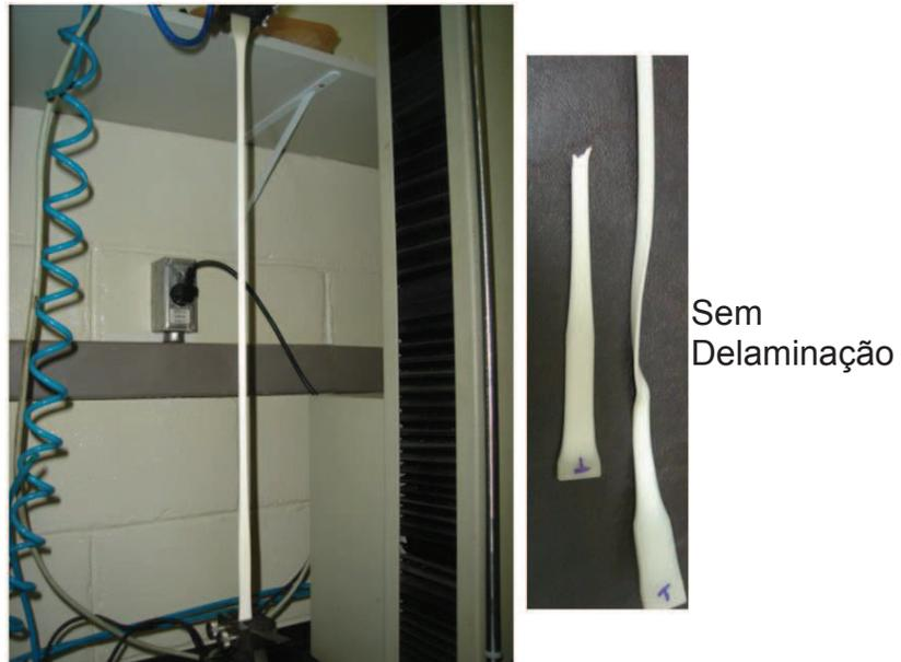
Figura 37. Foto dos corpos de prova da formulação Br 96-4.
