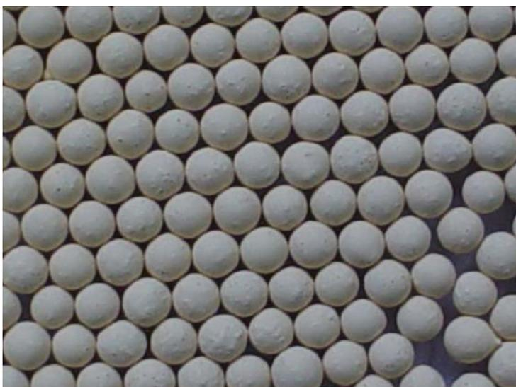
**Figura 6.2.7** - Esferas de zeólita 4A envelhecidas (**ESFZEO4AE**).
