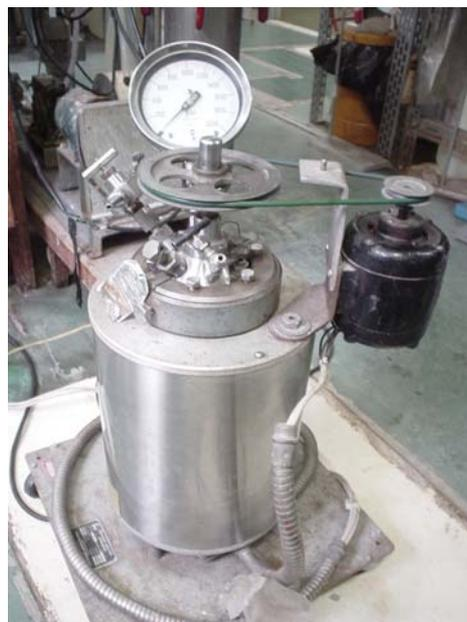
**Figura 5.3.2** - Autoclave utilizada na síntese da zeólita 4A.
