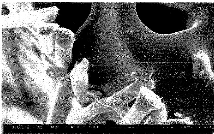
Figura 22 - Micrografia transversal da fibra de Aramida.
