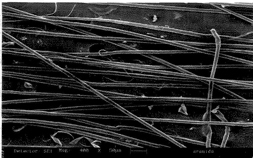
Figura 21 - Micrografia longitudinal das fibras de aramida
