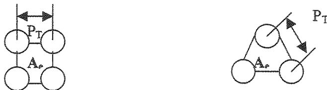
Figura 5: Disposição quadrada e triangular dos tubos.
