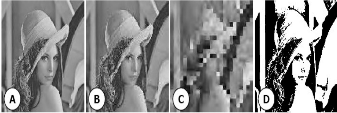
Figura 18: Influência da variação do número de amostras e de níveis de quantização na qualidade de uma imagem digital: (A) 200 x 200 pixels / 256 níveis; (B) 100 x 100 pixels / 256 níveis; (C) 25 x 25 pixels / 256 níveis; e (D) 200 x 200 pixels / 2 níveis
