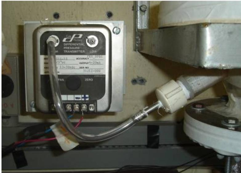
Figura 3.18 - Foto do transdutor e da tomada de pressão.
