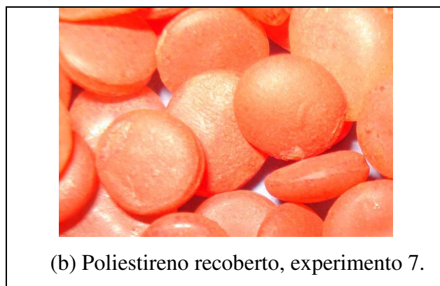
Figura 4.1.2 – Partículas de poliestireno: (a) antes do recobrimento e (b) recobertas.
