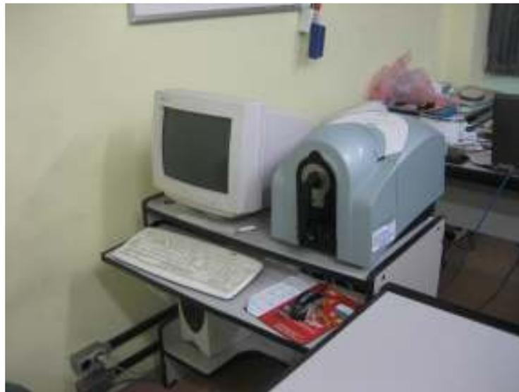
**Figura 14:** Espectrofotômetro Datacolor modelo *Spectralflash*<sup>®</sup> *SF350X*.
