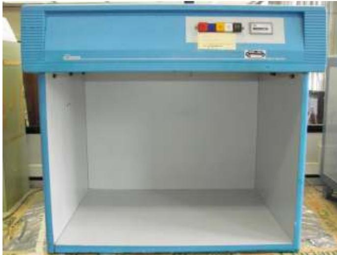
**Figura 15:** Cabine de luz BYK Gardner modelo Byko-spectra.
