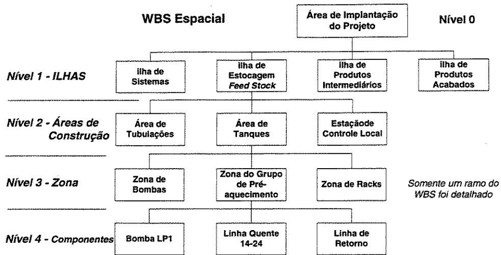
Figura 4.16 – Exemplo de WBS Baseado na Lógica Espacial para Área Petroquímica (Adaptado de Bruzzone, 1999)
