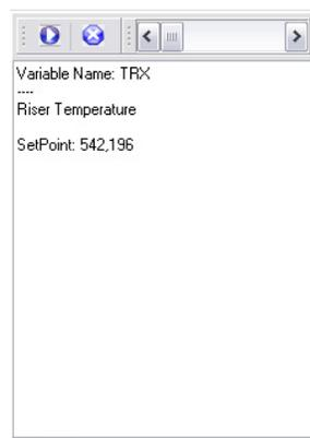
Figura 74: Janela para ativação da simulação e visualização da descrição das variáveis.
