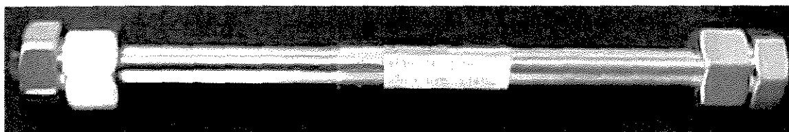
Figura 3.2 – Coluna em aço inoxidável de 25 x 1 cm e diâmetro de partícula de 16 \mu\text{m}
