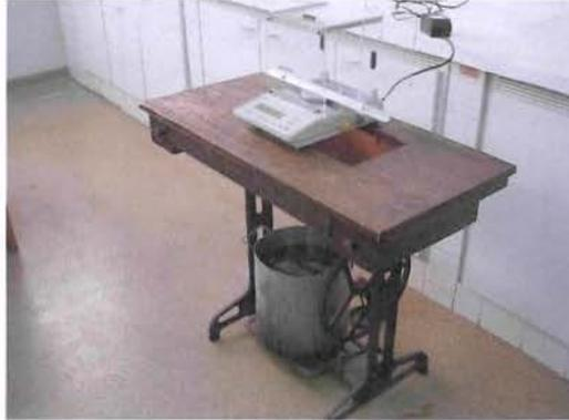
Figura 34: Balança Hidrostática – Laboratório FATEC - Americana
