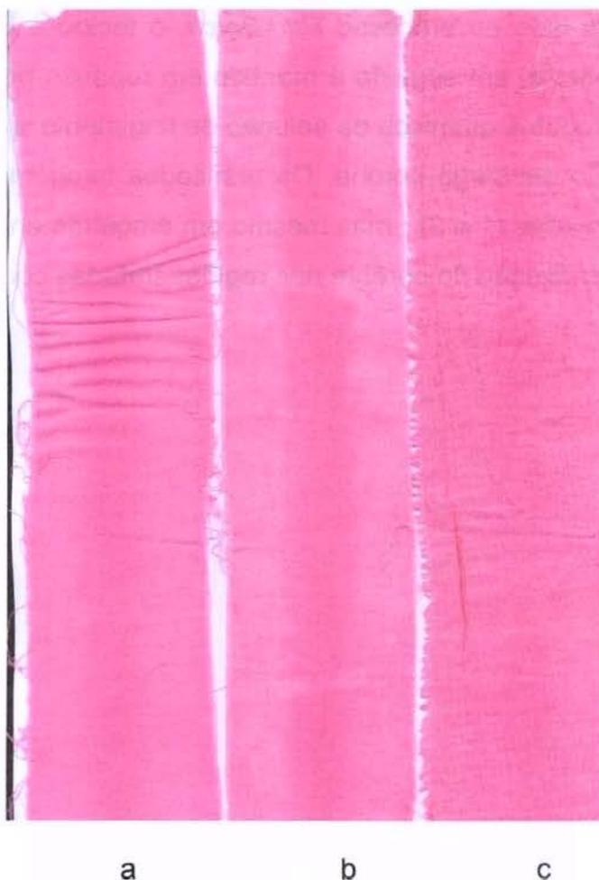
Figura 65: Amostra de tecido de algodão tratadas por 20 min. com corona e em seguidas tingidas com corante vermelho. (a): algodão desengomado tinto pelo processo *pad-batch*; (b): algodão desengomado tinto pelo processo *pad-dry-termofix* e (c): algodão engomado tinto pelo processo *pad-dry-termofix*.
