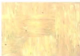
Fig.46: Micrografia de poliéster tratado com corona por 3s aplicado pigmento amarelo.
