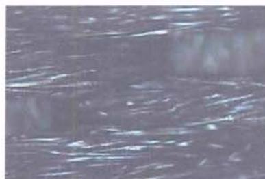
Fig.52: Micrografia de poliéster aplicado pigmento preto e ainda úmido tratado com corona por 3s. distância 6 mm novamente corona por 3s.
