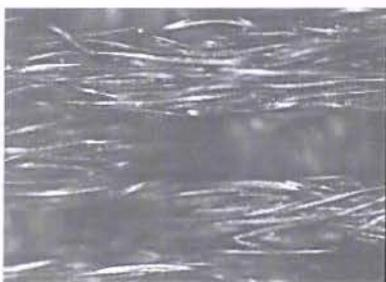
Fig. 51: Micrografia de poliéster tratado com corona por 3s e aplicado pigmento preto. Distância 6 mm aplicado corona novamente por 3s.
