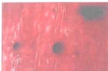
Fig.37: Micrografia de poliéster tratado com corona por 10s e aplicado pigmento vermelho.
