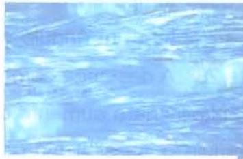
Fig.40: Micrografia de poliéster tratado com corona por 5s e aplicado pigmento azul.
