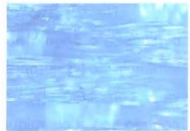
Fig 45: Micrografia de poliéster aplicado pigmento azul e ainda úmido tratado com corona por 2s
