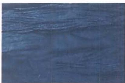
Fig. 53: Micrografia de poliéster aplicado pigmento preto e depois de seco tratado com corona por 3s. distância 6 mm.
