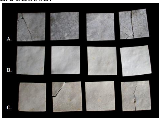
Figura 34. Aspecto visual das amostras após 30 dias de degradação em composto: A. PLA; B. PLA/CLO20A e C. PLA/CLO30B.
