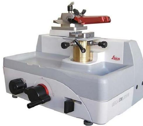
Figura 3.13 Micrótomo utilizado para os cortes de biomassas
