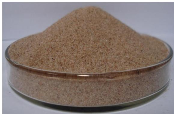
Figura 3.3 Areia quartzosa utilizada para os ensaios fluidodinâmicos
