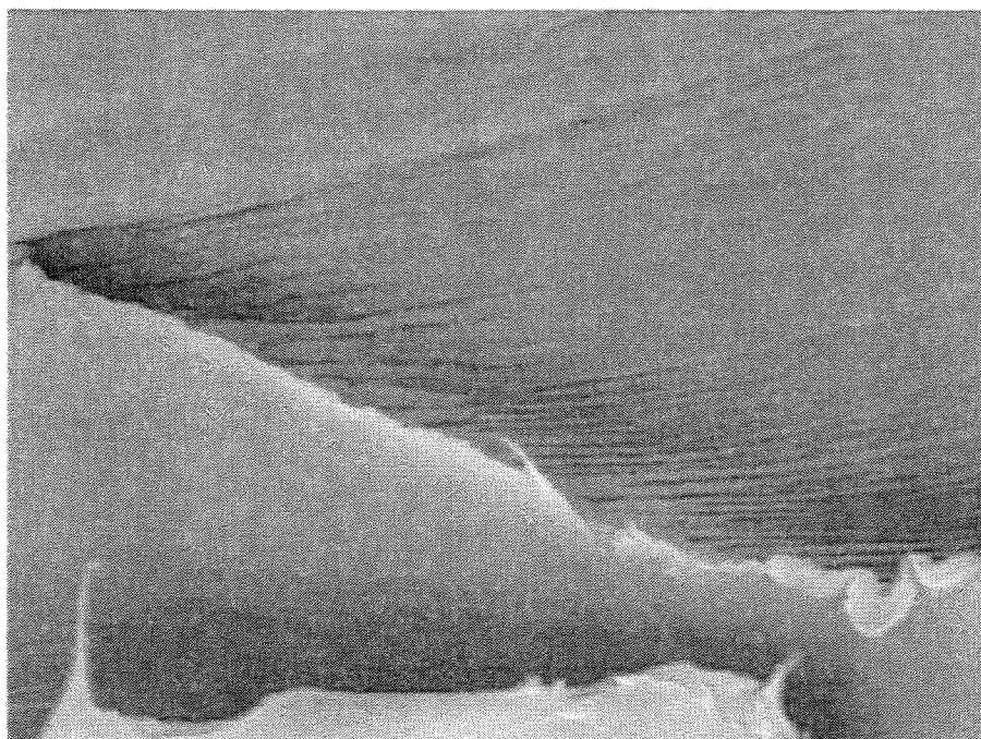
Figura 6.159 - Polímero 6 (IPA (-) , DEG (+)) 105°C - Corte Transversal - 3.300x
