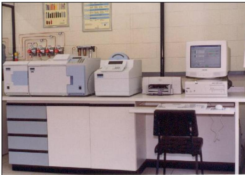
Figura 3.5 – Fotografia do sistema analítico (ATD/GC/FID/MS) existente no Laboratório de Pesquisa e Desenvolvimento de Tecnologias Ambientais (LPDTA/FEQ/UNICAMP). Fonte: SOUSA (2002).
