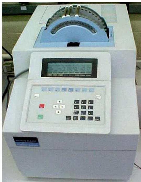
Figura 3.10 – Esquema de colocação de tubos adsorventes no carrossel do dessorvedor térmico automático ATD-400.
