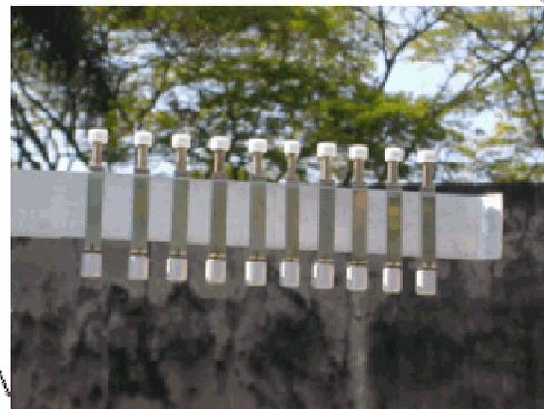
Figura 5.2 – Esquema de colocação dos amostradores passivos nas instalações da estação Pinheiros de monitoramento da qualidade do ar.
