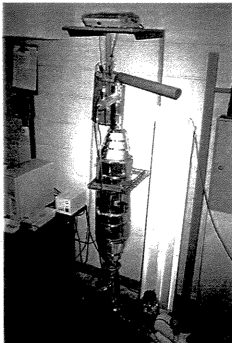
Figura 3.6 – Detalhe fotográfico do sistema de secagem em leito fixo.
