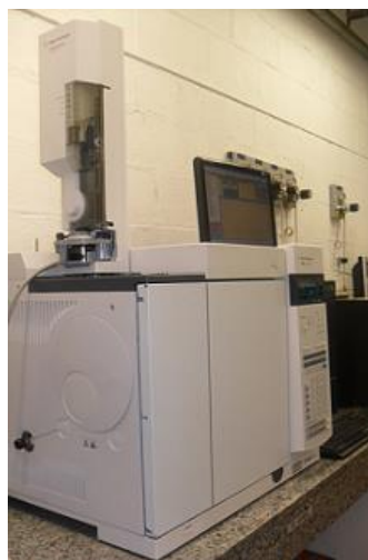
Figura 3.27 - Sistema cromatográfico utilizado para a técnica HT-SimDis-GC
