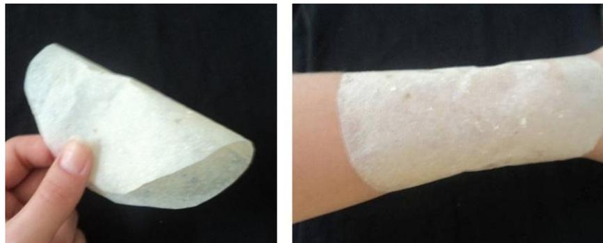
**Figura 4.10** – Flexibilidade das formulações preparadas com 10% de Silpuran<sup>®</sup> 2130 A/B com adição de 11% de AlphaSan<sup>®</sup> RC2000.
