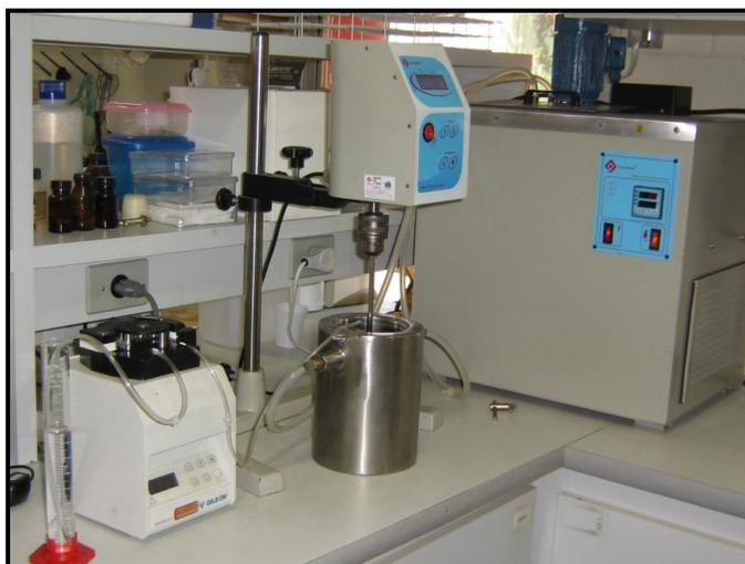
**Figura 3.1** – Sistema de produção do complexo polimérico.
