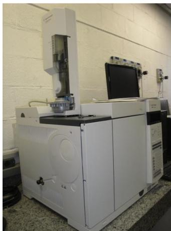
**Figura 8.1** Sistema cromatográfico utilizado para a técnica HT- SimDis GC
