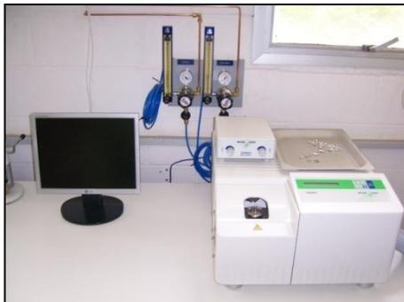
**Figura 5.2** Sistema térmico de calorimetria diferencial de varredura DSC, instalado no LOPCA -FEQ
