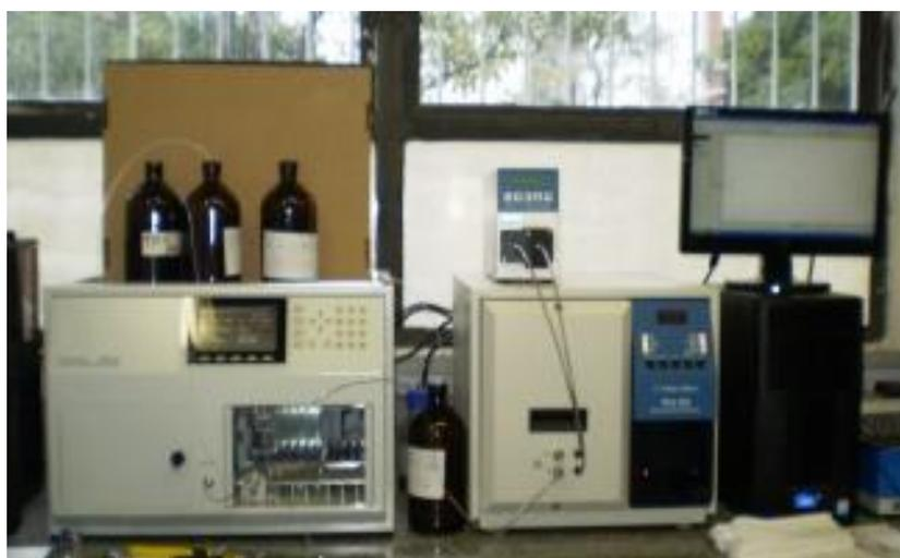
**Figura 7.1** Cromatógrafo GPC MAX modelo TDA 320 instalado no laboratório LOPCA/LPDS
