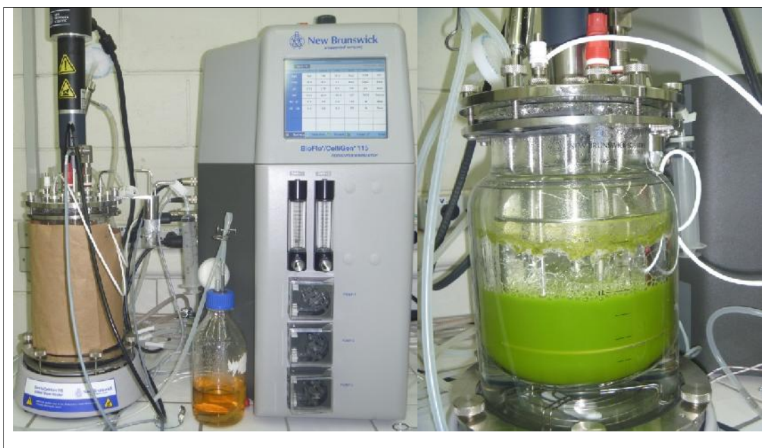
Figura 23: Fermentação empregando sacarose hidrolisada como fonte de carbono para a C. vulgaris .
