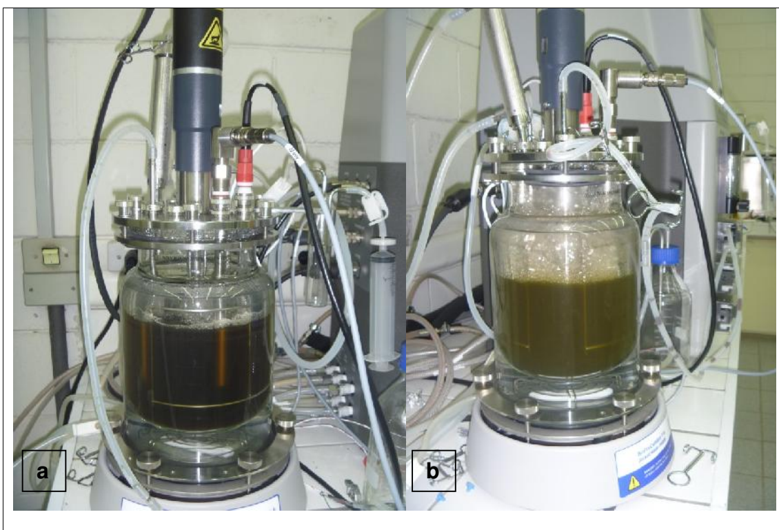
Figura 26: Fermentação empregando melaço de cana hidrolisado como fonte de carbono para a C. vulgaris . Início da fermentação (a), final da fermentação (b).
