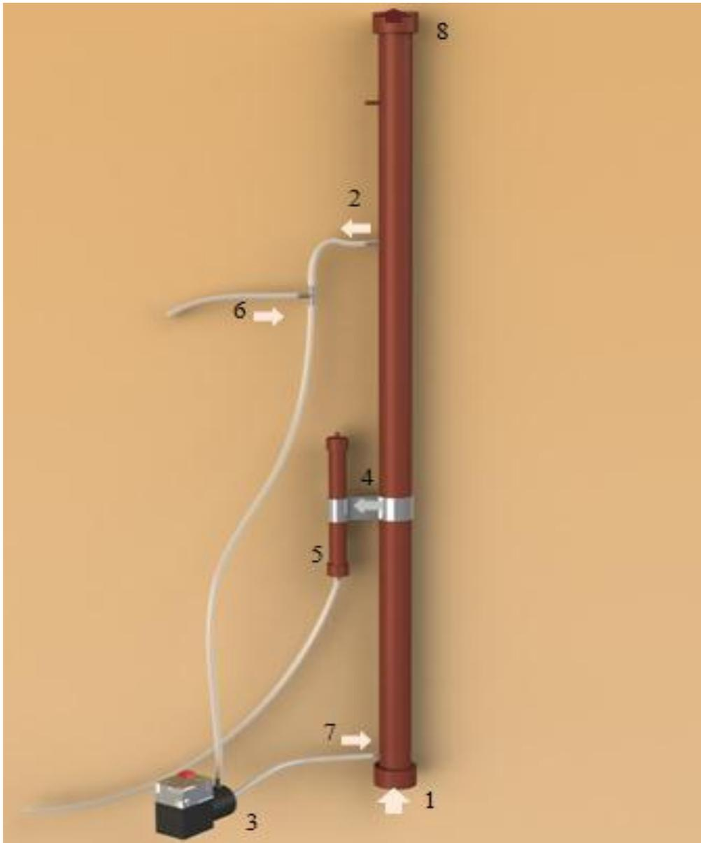
**Figura 3.1** Coluna de borbulhamento utilizada no estudo de **MOCHI (2010)**: (1) entrada da mistura gasosa oxigênio-ozônio; (2) saída do líquido da recirculação; (3) bomba centrífuga; (4) ponto de amostragem; (5) degasificador; (6) retorno do líquido amostrado; (7) retorno do líquido da recirculação; (8) saída da mistura gasosa (oxigênio-ozônio)
