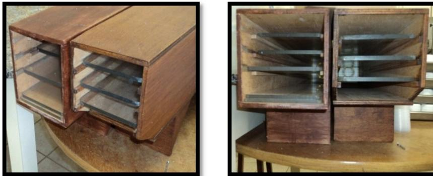
Figura 3.4 - Túnel com circulação de ar usado na secagem dos filmes após a reticulação complementar.
