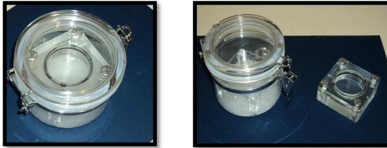
Figura 3.5 – Sistema utilizado na determinação da permeabilidade ao vapor de água.
