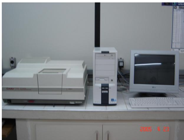
Figura 17 – Espectrofotômetro Varian-1G do LRAC.
