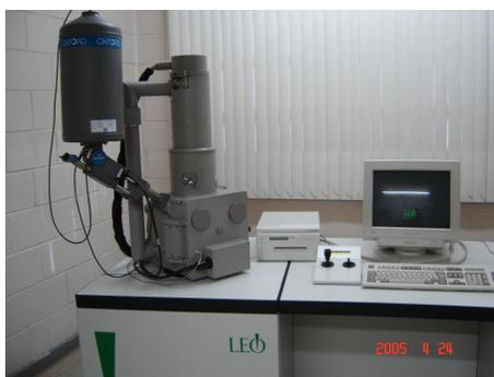
Figura 19 – Microscópio LEICA-Leo 440i.
