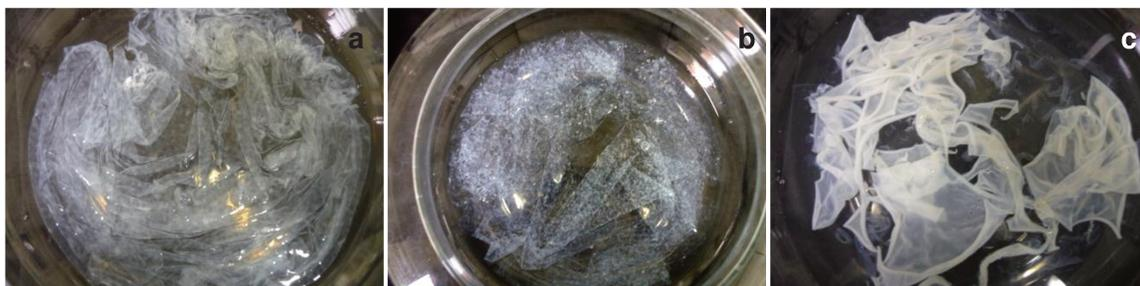
Figura 4.2: Membranas de quitosana e goma arábica durante a lavagem preparadas a partir de soluções: (a) 0,5% Q: 0,5% GA; (b) 0,5% Q: 1,0% GA e (c) 0,5% Q: 2,0% GA.
