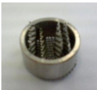
Figura 3.3: Suporte para acomodação das amostras instalado no interior da célula de alta pressão.
