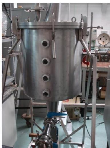
Figura 5.1: Autoclave cilíndrica envoltória da cavidade de aplicação de micro-ondas, com os visores para observação do leito.
