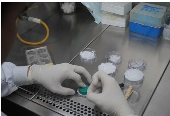
Etapa 1: Corte das amostras de nanofibras nas dimensões da placa de 6 poços.
