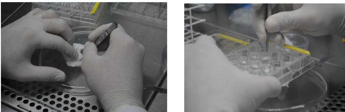
Figura 24: Segundo ensaio de adesão celular, utilizando suportes cilíndricos acrílicos para fixar as nanofibras no fundo dos poços (Laboratório de Anatomia/IB/UNICAMP)
