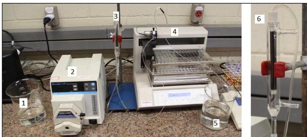
Figura 3.3 – Sistema de ensaios dinâmicos em que se pode ver: (1) solução metálica de alimentação; (2) bomba peristáltica; (3) coluna empacotada; (4) coletor de amostras; (5) solução de saída da coluna que não foi coletada e; (6) detalhe da coluna.
