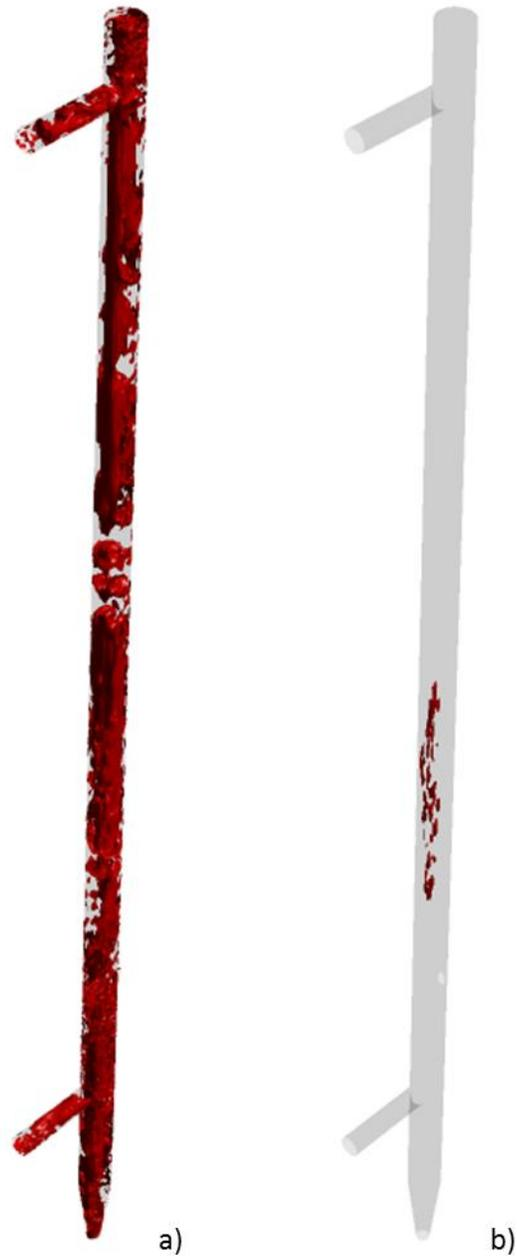
Figura 33. Isosuperfícies no leito fluidizado em 10 s de simulação do Caso 2 para os desequilíbrios mássicos de: a)  $1.10^{-11}$  kg/s; b)  $1.10^{-8}$  kg/s .
