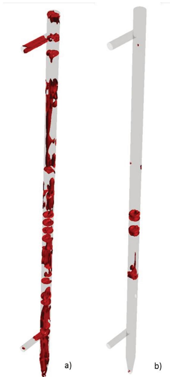
Figura 14. Isosuperfícies no leito fluidizado em 10 s de simulação para os desequilíbrios mássicos de: a)  $1 \cdot 10^{-11}$  kg/s; b)  $1 \cdot 10^{-9}$  kg/s .
