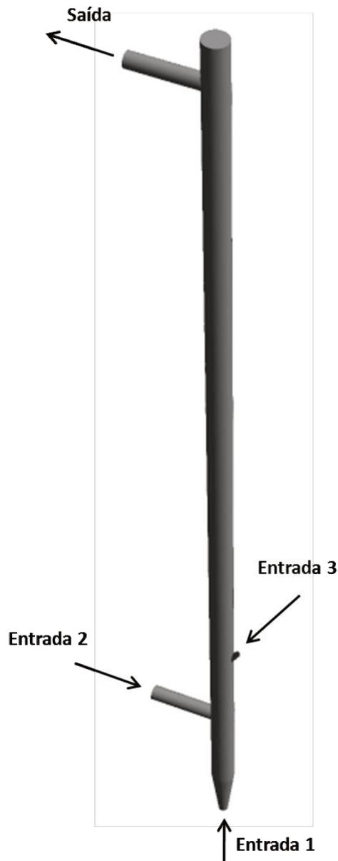
Figura 28. Detalhes das entradas e saída na geometria criada para o leito fluidizado do CFBC para o estudo de combustão.
