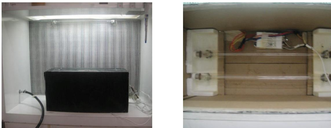
**Figura 2.** Caixa de luz UV utilizada para a mutagênese. **Esquerdo:** posição da caixa dentro do fluxo laminar. **Direito:** posição das lâmpadas UV.
