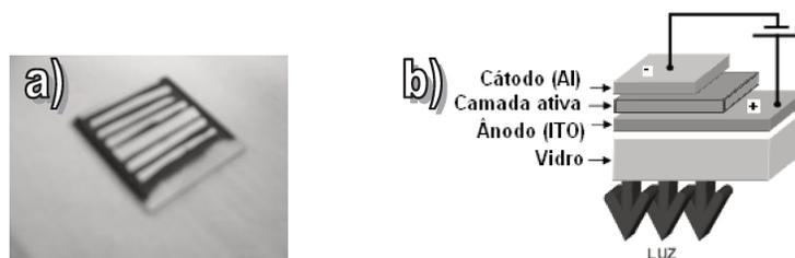
Figura 30. Medida de condutividade, a) imagem dispositivo e b) esquema de conexão
