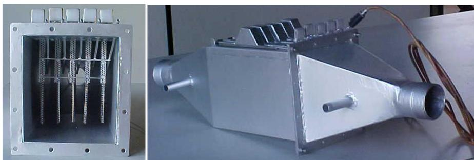
Figura 3. 5 Vista transversal e lateral do secador convectivo (VIEIRA , 2006).
