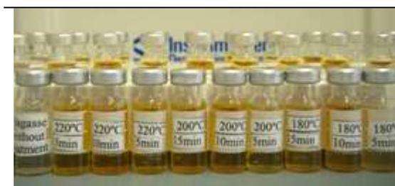
**Figura 26.** Filtrados após tratamento térmico em diferentes temperaturas (220, 200 e 180°C) e tempos (5, 10 e 15 min). Material utilizado para análise de açúcares (glicose e xilose), lignina solúvel e ácido acético.
