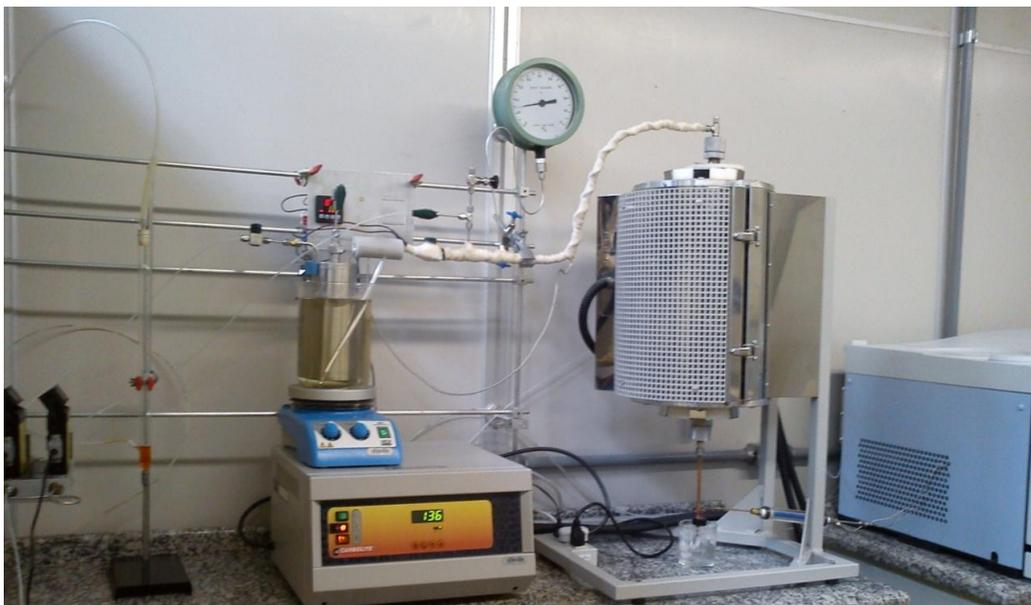
Figura 3.2: Imagem da linha reacional utilizada nos testes catalíticos.
