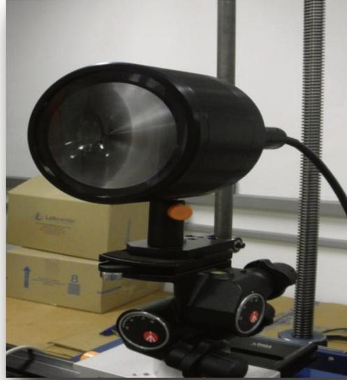
**Figura 3.7** Laser e difusor óptico para sistema *Shadow*.
