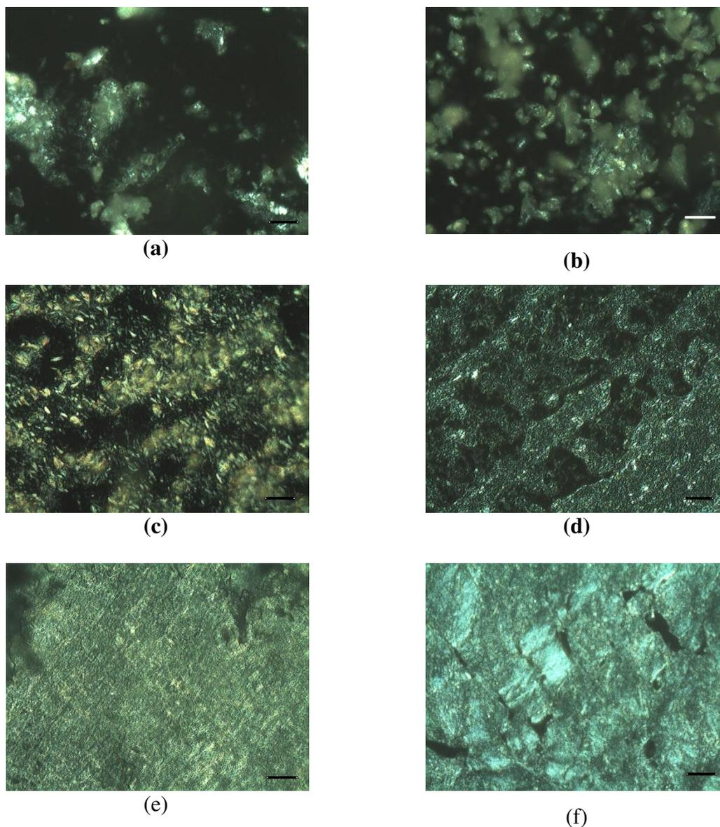
**Figure 4.** Micrographs obtained by PLM (a) Dynasan<sup>®</sup>114, (b) Dynasan<sup>®</sup>118, (c) Dynasan<sup>®</sup>114 and Miglyol<sup>®</sup>812 (70:30); (b) Dynasan<sup>®</sup>114 and Miglyol<sup>®</sup>840 (70:30); (c) Dynasan<sup>®</sup>118 and Miglyol<sup>®</sup>812 (70:30); (d) Dynasan<sup>®</sup>118 e Miglyol<sup>®</sup>840 (70:30).
