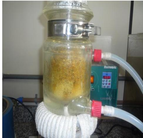
**Figura 5. 1:** Reator utilizado no pré-tratamento com peróxido de hidrogênio alcalino.
