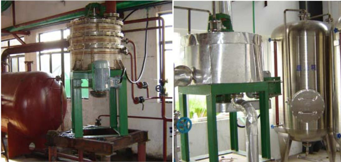
**Figura 2.7 - Aplicação industrial do RZB para recuperação de metanol (esquerda) e etanol (direita) no processo de destilação contínua (Wang *et al.*, 2010).**
