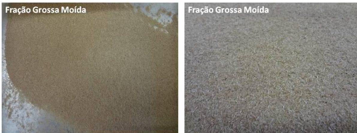
Figura 24: Fração grossa moída que foi submetida à hidrólise enzimática. (Observação: a fotografia da esquerda obtida a uma distância de aproximadamente 30 cm e da direita a aproximadamente 10 cm.) (ALMEIDA, 2011i)
