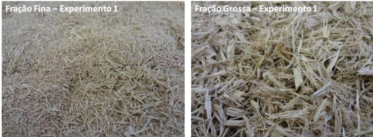
Figura 19: Frações finas e grossas obtidas no equipamento de classificação pneumática utilizando os valores da taxa de alimentação de bagaço e vazão de ar do experimento 1. (ALMEIDA, 2011d)
