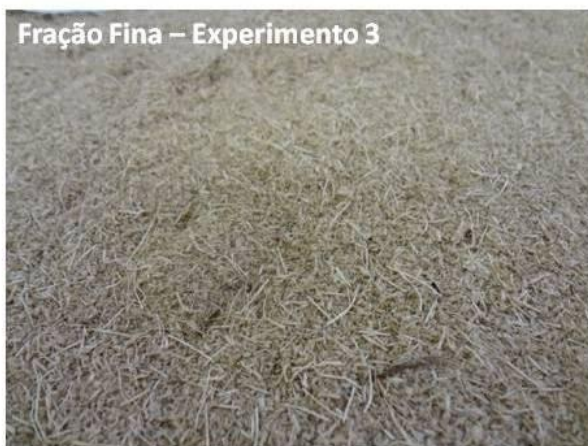
Figura 21: Frações finas e grossas obtidas no equipamento de classificação pneumática utilizando os valores da taxa de alimentação de bagaço e vazão de ar do experimento 3. (ALMEIDA, 2011f)
