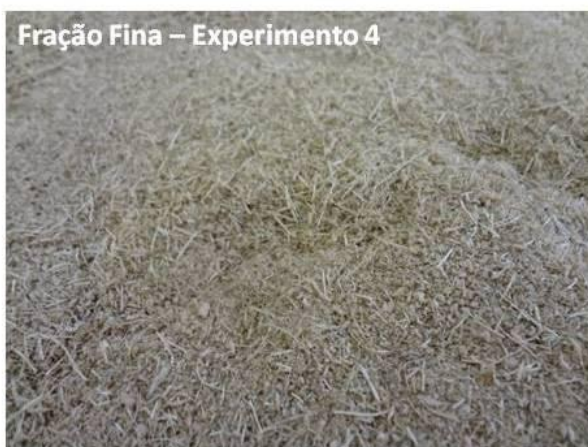
Figura 22: Frações finas e grossas obtidas no equipamento de classificação pneumática utilizando os valores da taxa de alimentação de bagaço e vazão de ar do experimento 4. (ALMEIDA, 2011g)
