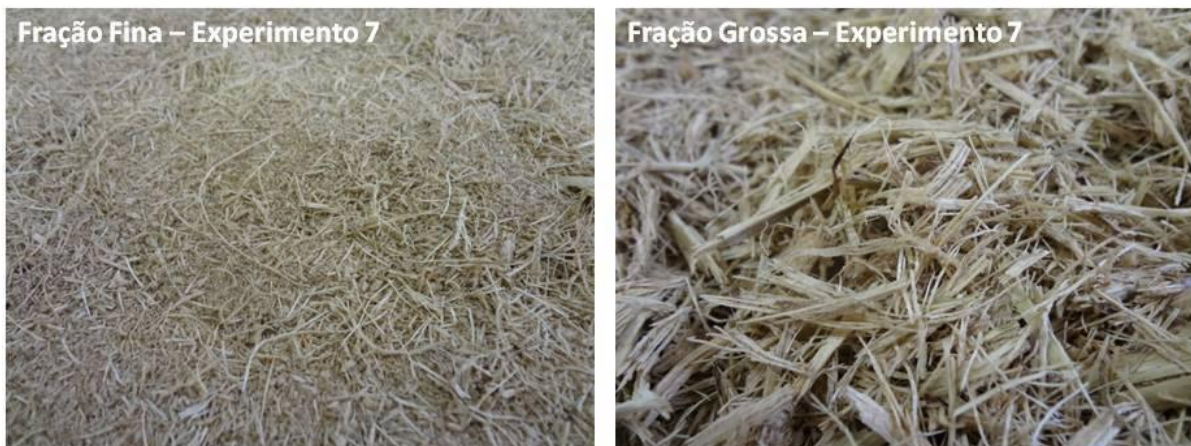
Figura 23: Frações finas e grossas obtidas no equipamento de classificação pneumática utilizando os valores da taxa de alimentação de bagaço e vazão de ar do experimento 7. (ALMEIDA, 2011h)
