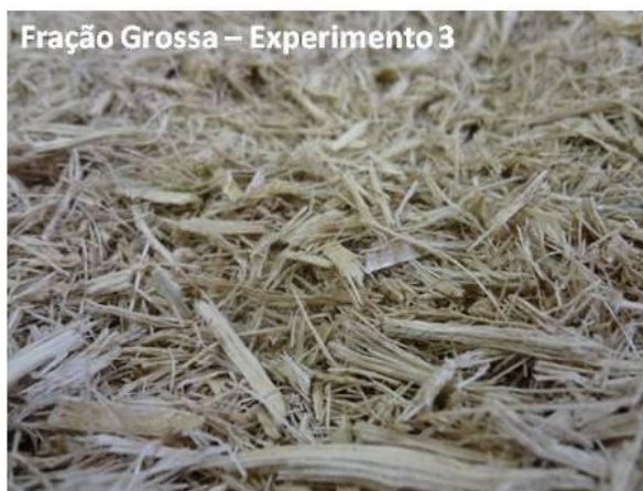
Figura 21: Frações finas e grossas obtidas no equipamento de classificação pneumática utilizando os valores da taxa de alimentação de bagaço e vazão de ar do experimento 3. (ALMEIDA, 2011f)
