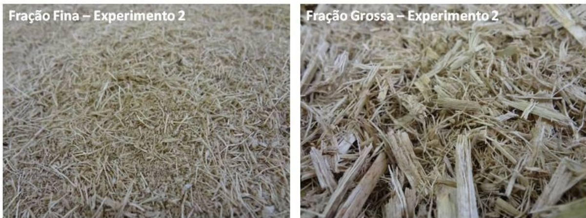
Figura 20: Frações finas e grossas obtidas no equipamento de classificação pneumática utilizando os valores da taxa de alimentação de bagaço e vazão de ar do experimento 2. (ALMEIDA, 2011e)
