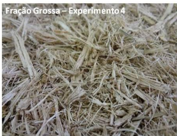
Figura 22: Frações finas e grossas obtidas no equipamento de classificação pneumática utilizando os valores da taxa de alimentação de bagaço e vazão de ar do experimento 4. (ALMEIDA, 2011g)
