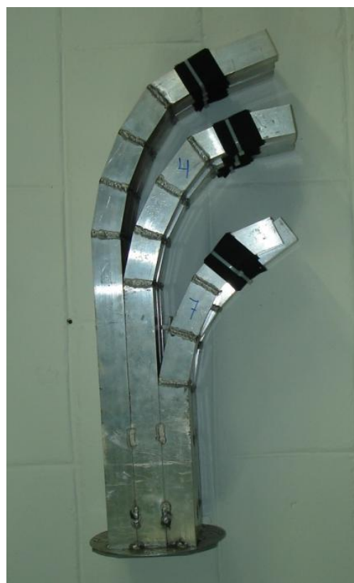
Figura 3.8 – Coletor de alumínio com “velcro” para fixar os sacos de tule.
