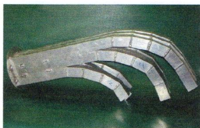
Figura 7: Vista lateral do coletor de alumínio para estudo da distribuição das partículas após o tê.
