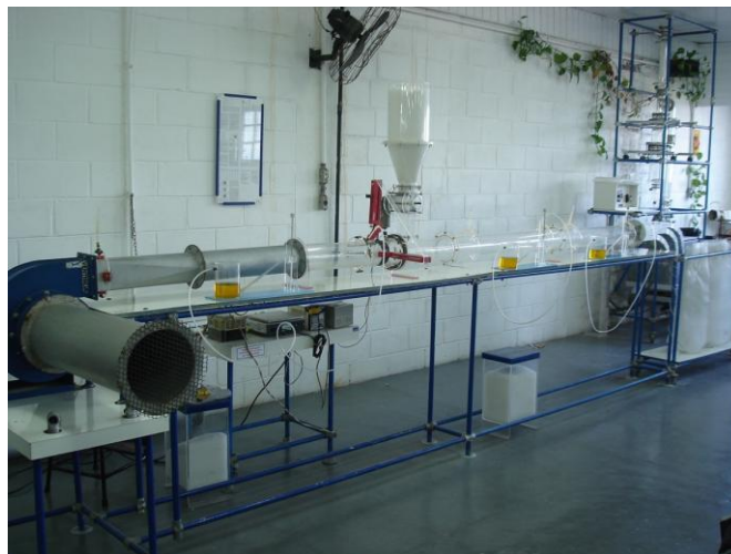
Figura 2.9 - Unidade piloto de transporte pneumático em fase diluída com motor de rotação variável em balanço, direcionador de fluxo, tubos de Pitot, alimentador rotativo, anéis piezométricos, manômetros com tubo inclinado e coletor de partículas no fim do duto horizontal.
