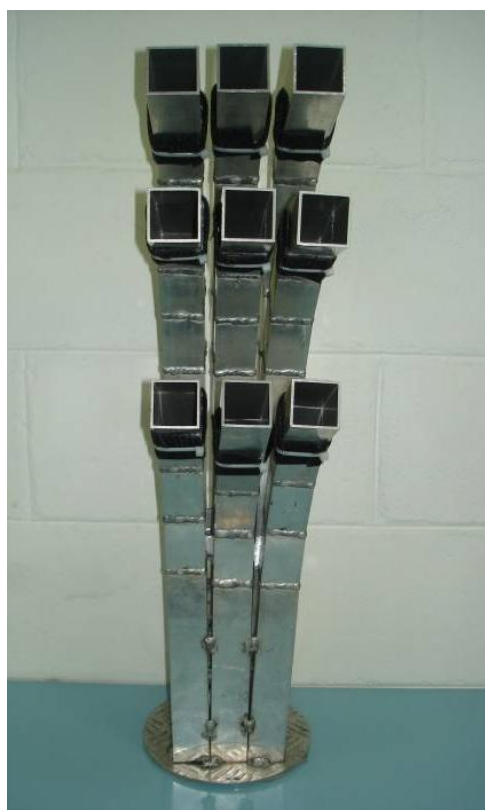
Figura 3.8 – Coletor de alumínio com “velcro” para fixar os sacos de tule.
