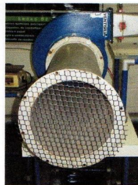
Figura 3: Ventilador centrífugo acoplado a motor com rotação variável.
