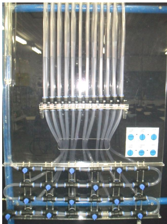
Figura 3.9 - Banco de piezômetro para leitura simultânea das pressões nos dutos.
