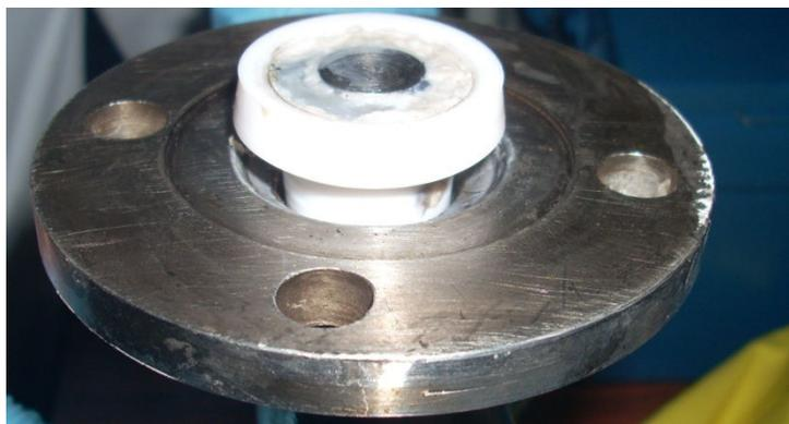
Figura 4.5. Sede e sistema de vedação original da válvula de fundo.
