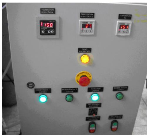
Figura 4.3. Painel de Controle da Unidade Experimental.
