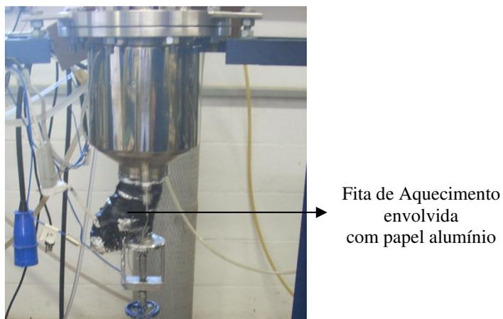
Figura 4.4. Válvula de fundo com a fita de aquecimento.
