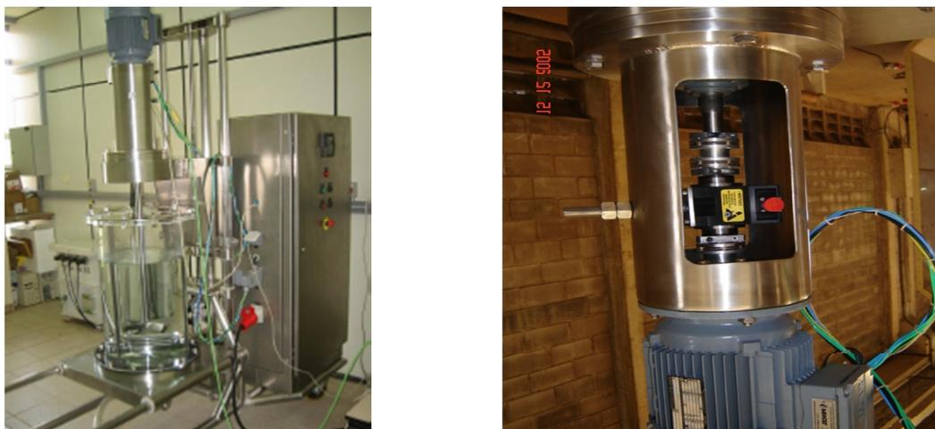
**Figura 58 – Sistema de agitação piloto.**
