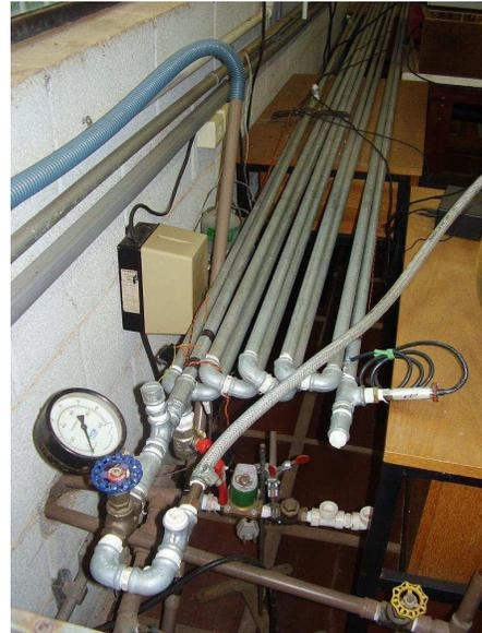
**Figura 3.4 – Tubulação ferro galvanizado.**
