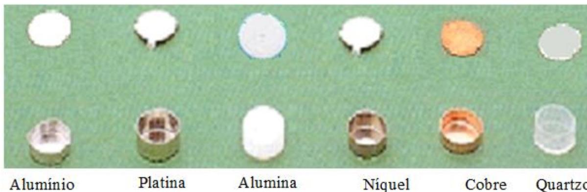
**Figura 6** – Diferentes tipos de Cadinho para DSC (PRADO, 2004).
