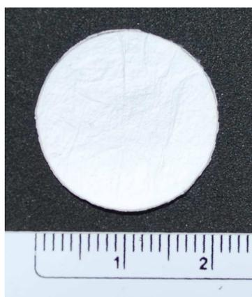
**Figura 46:** Imagem da membranas de nanofibra de acetato de celulose com 50 % de sulfato de Gentamicina, revestida com HPMC.
