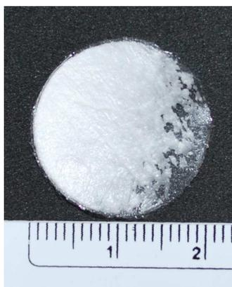
**Figura 49:** Membranas de nanofibra de acetato de celulose com 50 % de sulfato de Gentamicina, revestida com Eudragit® L100.
