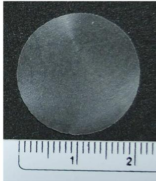
**Figura 43:** Membranas “casting” de acetato de celulose com 50 % de sulfato de Gentamicina.
