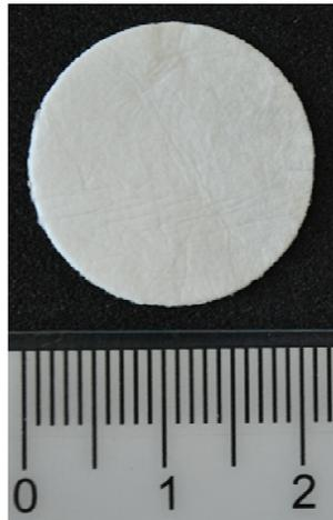
**Figura 41:** Membranas de nanofibra de acetato de celulose com 50 % de sulfato de Gentamicina
