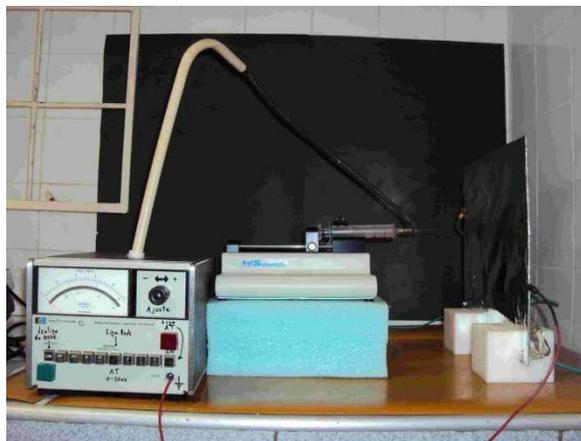
**Figura 8:** Foto do equipamento utilizado para eletrofiação do Acetato de Celulose.
