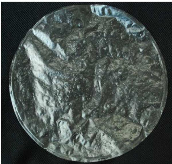
Figura 4.9 – Aspecto da membrana com proporção polimérica de X:Q de 1:1 preparada com xantana produzida em escala piloto, desaerada e sem adição de tensoativos.
