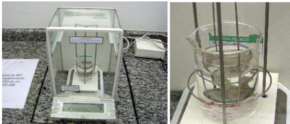
Figura 8.2 – Sistema de ensaio para determinação de massa específica aparente. (CETEA, 2009)
