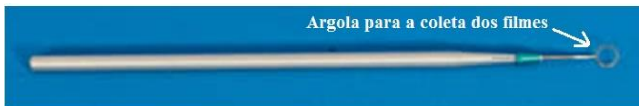
Figura 10.Argolas artesanais ou Perfect Loop para a coleta dos filmes ultrafinos sobre a água. Fonte: Adaptado de Electron Microscopy Science (2010).
